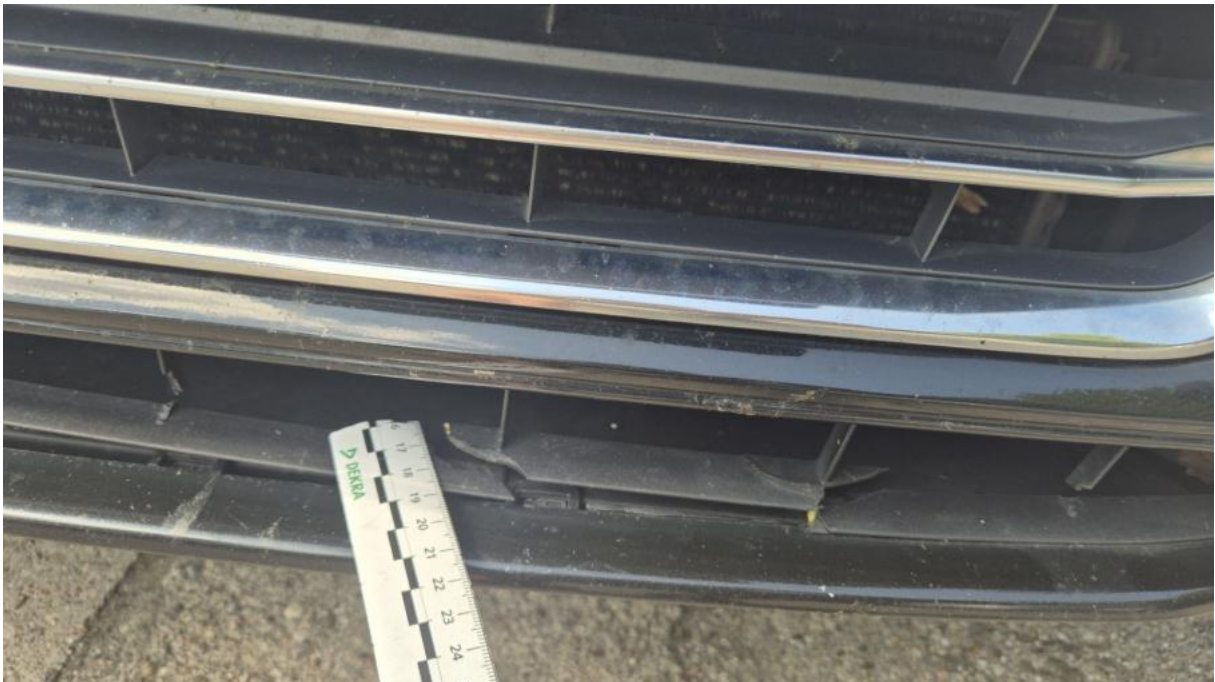
Fot. 38 Kratka zderzaka prz. - Pęknięcie/rozerwanie 1
