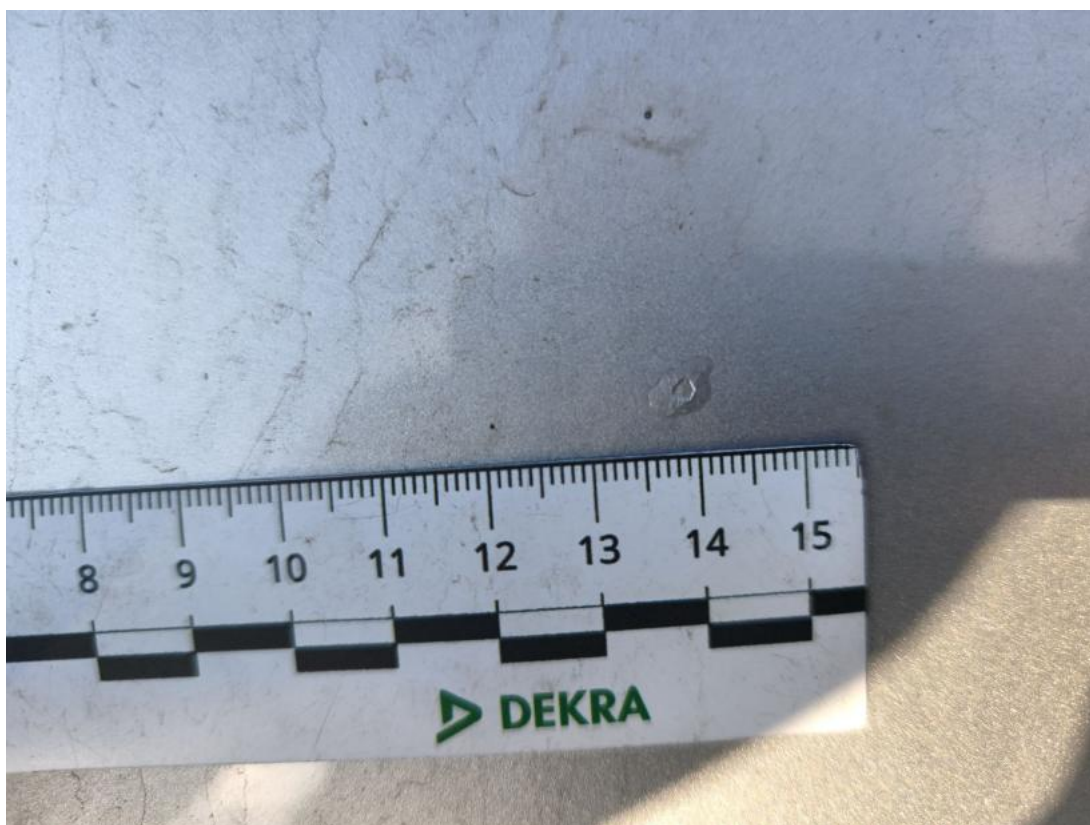
Fot. 40 Pokrywa komory silnika - Rysa/odprysk 1
