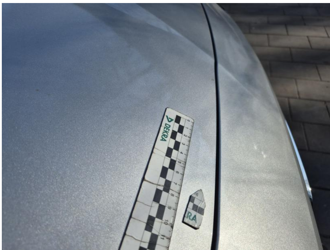
Fot. 34 Pokrywa komory silnika - Wgniecenie/odkształcenie 1
