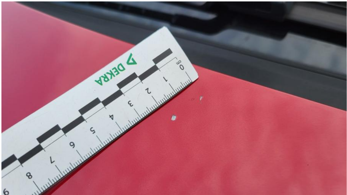
Fot. 34 Pokrywa komory silnika - Rysa/odprysk 1
