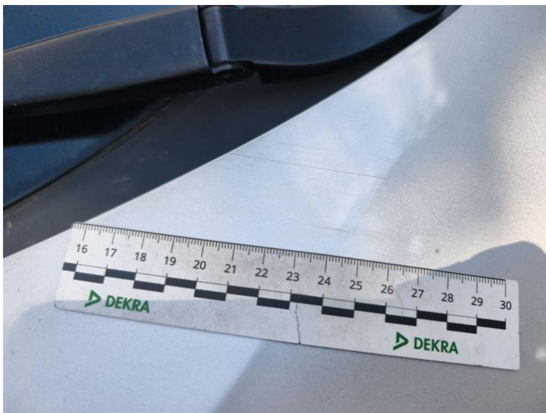
Fot. 40 Pokrywa komory silnika - Rysa/odprysk 1
